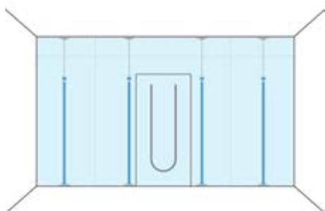
12 pcs. Séparation simple et rapide des locaux. Polyvalent en hauteur et en largeur: pour plafonds d'une hauteur max. de 2,90m et avec une largeur max. de 5m, couvrant également les angles. Extensible au moyen de supports d'assemblage (442220). Livraison : porte en feuille plastique, tape de masquage, feuille de masquage de 4x5 m, 4 supports télescopiques, 5 pinces à ressort et sac de transport.
