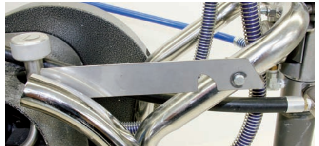
Splint durch Rahmen und Adapter führen und Sprengling montieren
