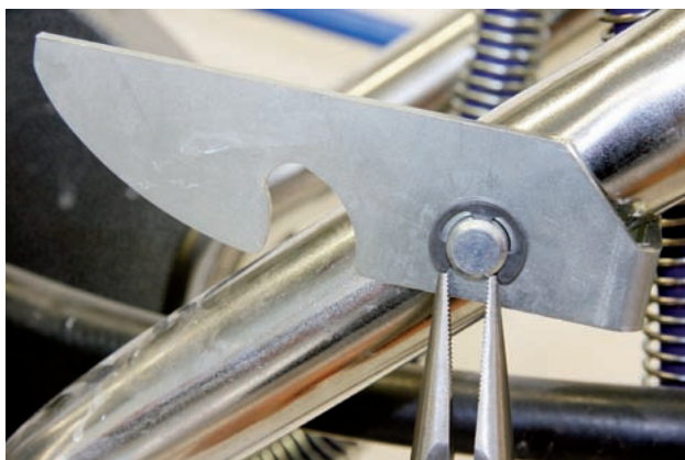
Far passare la copiglia attraverso il telaio e l'adattatore e montare l'anello di sicurezza
