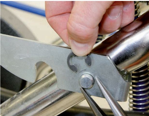
Demontage Sprengling mit Sprenglingzange
