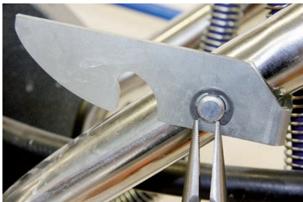
Závlačku prostrčte rámem a adaptérem a namontujte rozpěrný kroužek
