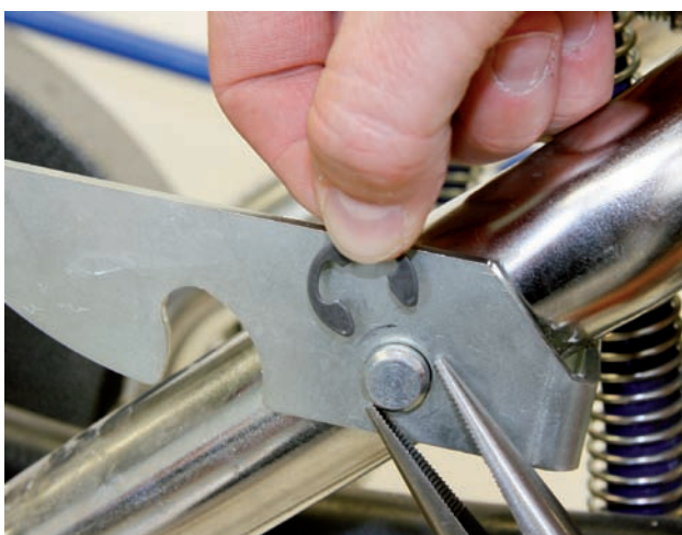
Demontáž rozpěrného kroužku s kleštěmi na rozpěrný kroužek
