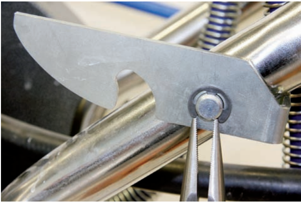
Introduire la goupille à travers le bâti et l'adaptateur et monter le circlip
