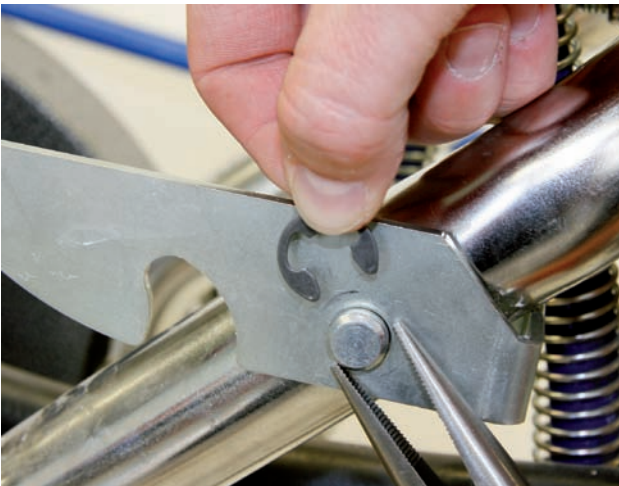
Démontage circlip avec pince à circlips
