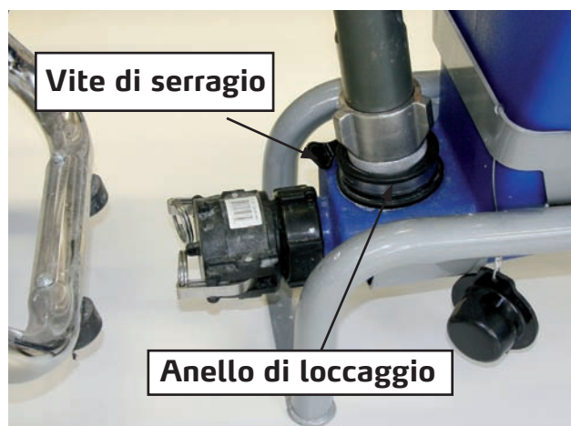
Fissare l'anello di bloccaggio sopra la vite di serraggio.
