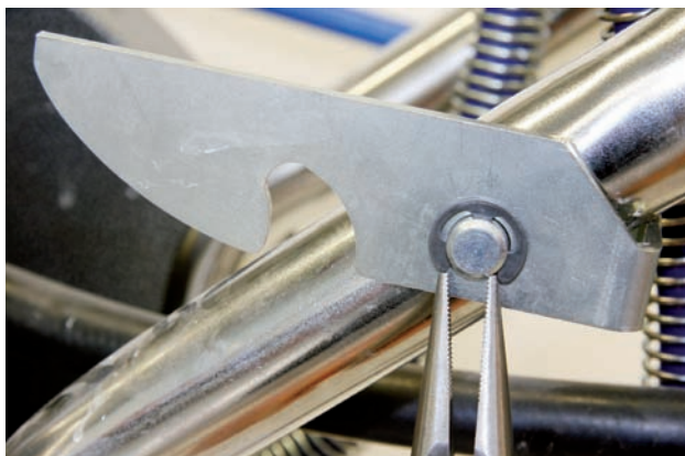
Pen door frame en adapter steken en springring monteren
