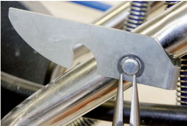
Splint durch Rahmen und Adapter führen und Sprengling montieren
