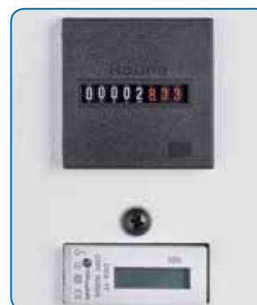
Contrôle de la durée d'exploitation quotidienne par le compteur des heures d'exploitation et de la consommation électrique
