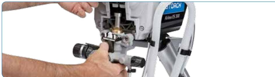
Le système Quick-Reload vous permet de remplacer en un tour de main un niveau de couleur épuisé afin de pouvoir poursuivre le travail immédiatement. Temps de réparation courts grâce à un dépannage interne, ce qui réduit les interruptions de travail prolongées.
